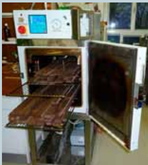
Komora za termično modifikacijo lesa
