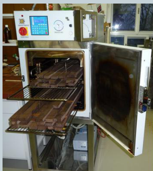
Komora za termično modifikacijo lesa
